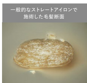
一般的なストレートアイロンで 施術した毛髪断面 毛髪形状は押し潰されている。
